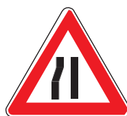
FIG. 18 ART. 90 STRETTOIA ASIMMETRICA A SINISTRA
