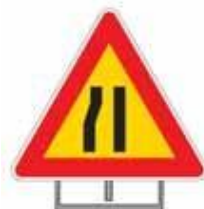
FIG. 385 ART. 31 STRETTOIA ASIMMETRICA A SINISTRA
