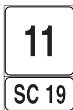
FIG. 268 ART. 129 PROGRESSIVA DISTANZIOMETRICA PER STRADA COMUNALE
