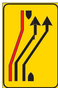
FIG. 413/c ART. 43 SEGNALE DI RIENTRO IN CARREGGIATA
