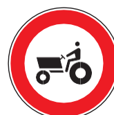
FIG. 62 ART. 117 TRANSITO VIETATO ALLE MACCHINE AGRICOLE
