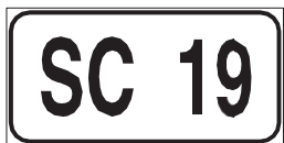
FIG. 260 ART. 129 SEGNALE IDENTIFICAZIONE STRADA COMUNALE
