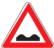
FIG. 1 ART. 85 STRADA DEFORMATA
