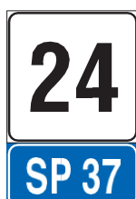
FIG. 267 ART. 129 PROGRESSIVA DISTANZIOMETRICA PER STRADA PROVINCIALE
